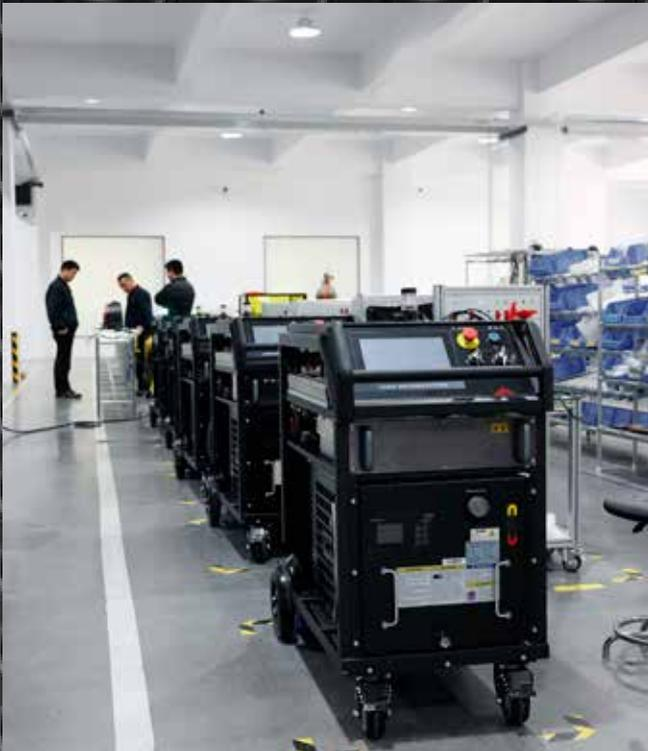
Die innovative handgeführte Laserschweißmaschine ist mit einem modularen Aufbau ausgestattet. Sie verfügt über eine leistungsstarke Bus-Steuerung, die die einzelnen Komponenten wie den Lasergenerator, den Kühler und das Galvanometer effizient koordiniert. Die offene Schnittstelle ermöglicht eine flexible Anpassung an unterschiedliche Anforderungen und gewährleistet eine optimale Prozesskontrolle für präzise Schweißergebnisse.
