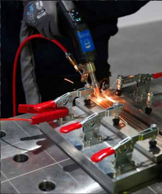
Der Schweißbrenner verfügt über einen ergonomischen Griff, ein QBH-Design gegen Lösen, eine verschleißfeste Ummantelung und V0-flammhemmende Materialien.
