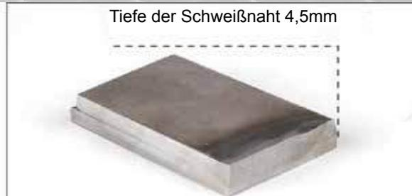
Die Laserschweißmaschine hat eine stabile und überraschende Leistung in den Schlüsseldaten erreicht, wie z.B. die Eindringtiefe beim Selbstfusionsstichschweißen und die Festigkeit beim Stumpfschweißen.
