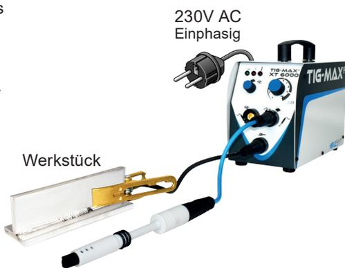
Die Isolierhülse bündelt die Fasern des Pinsels und dient für den Kontaktschutz!
