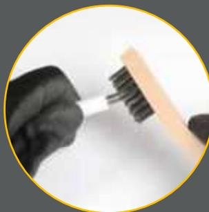
3. Falls sich auf oder in dem Gewinde von Pinsel, Stab oder Formgriff Beläge bilden, reinigen Sie diese mit der HSF-Drahtbürste (S. 36). Die Gewinde könnten sich sonst festfressen und die Reinigungsleistung könnte nachlassen oder komplett verloren gehen.
