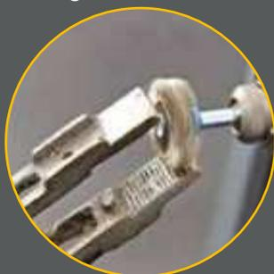
2. Reinigen Sie die Klemme und insbesondere die Zacken mit einer feinen Drahtbürste.
