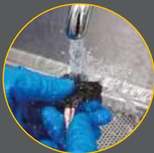
1. Spülen Sie die Pinsel nach jeder Schweißnahtreinigung gründlich mit warmem Wasser und lassen Sie sie sorgfältig trocknen, wobei darauf zu achten ist, dass die Fasern gerade liegen.
